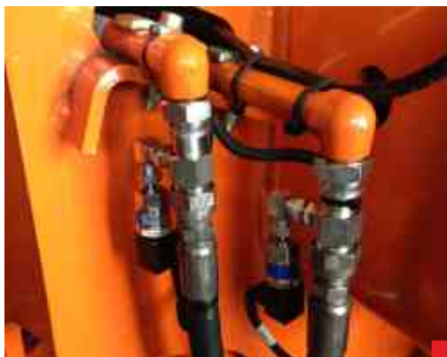
napojení snímače hydraulického tlaku
