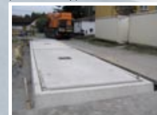
GRAVEX 18 concrete 60t osazená v prefabrikovaném zapuštěném základu 14-95
